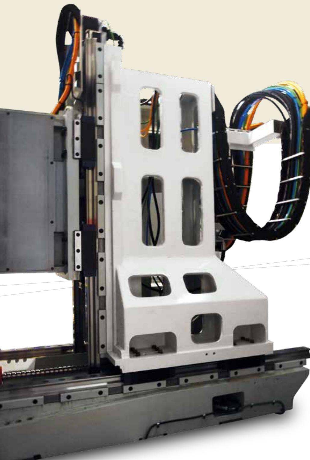
■ Slitta e montante poggiano sempre sulle guide. Evitato l'ondeggiamento dell'unità per mancanza di appoggio.
