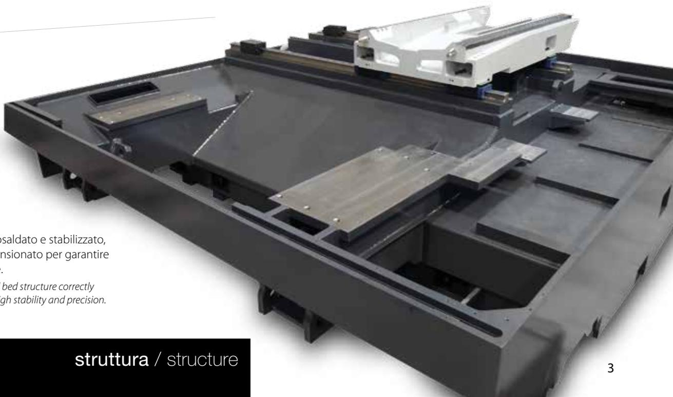
■ Basamento elettrosaldato e stabilizzato, correttamente dimensionato per garantire stabilità e precisione.
